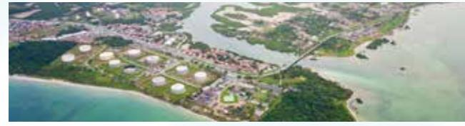
**Porto de Aratu** – Porto graneleiro, com quatro terminais especializados: produtos gasosos, com berço de 189m; granéis líquidos, com dois berços de 340m; e dois para granéis sólidos, com três berços com 366m.
